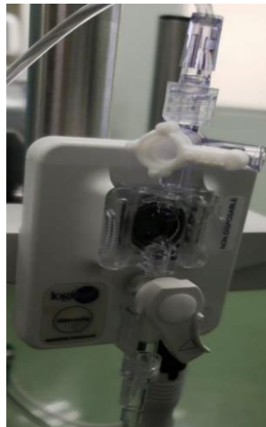
Imagen 15. Transductor de presión arterial invasiva colocado a la altura del corazón de la unidad experimental y calibrado a la presión atmosférica a la cual se realizó el experimento.
